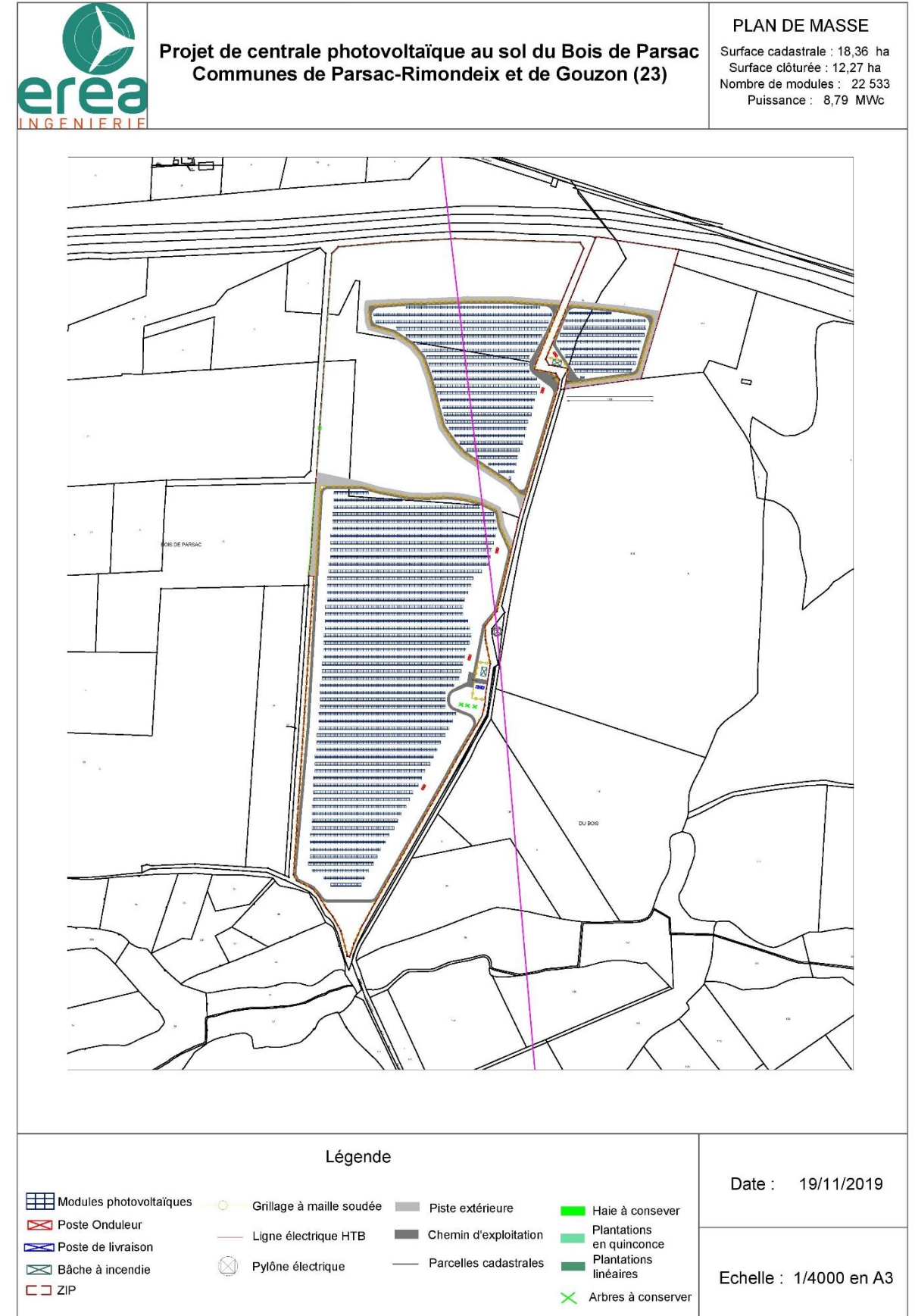
Figure 11 : Plan de masse du projet photovoltaïque
